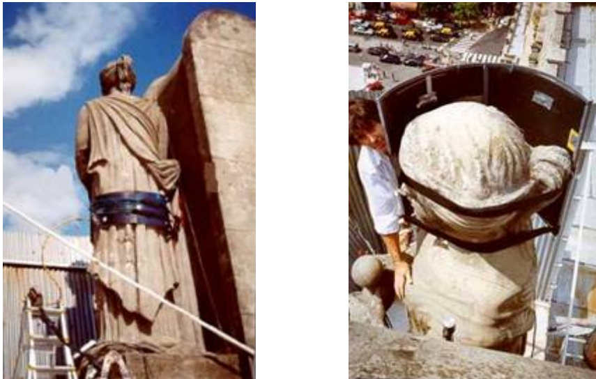
Figura 16. Disposición de las placas gammagráficas para el estudio de la cabeza y tronco de las estatuas del Palacio de Tribunales.
